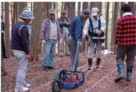
写真5 小型レーダ探査風景
