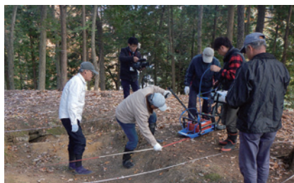
写真7 地域住民との共同作業での地中レーダ探査
