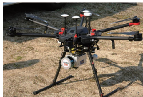
写真5 赤外線レーザーを搭載した樹冠上からの空撮用ドローン
